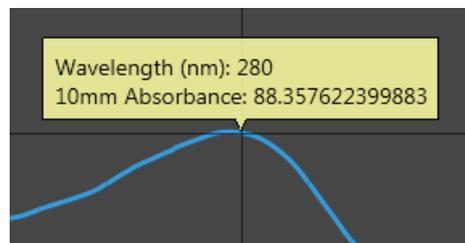
**注释** 您也可以沿着光谱的 X 轴拖曳以连续显示吸光值。
