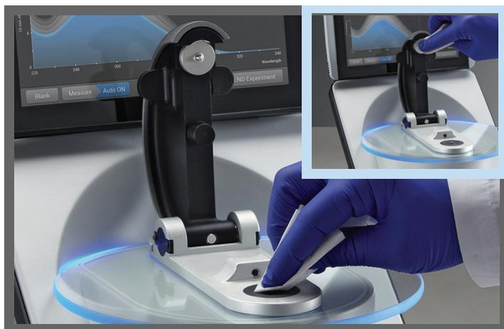
3. 抬起仪器检测臂，用新的实验室抹布擦拭上下基座。
